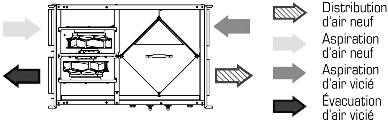
Réglage en usine. L'appareil peut être facilement inversé sur les lieux d'installation.
