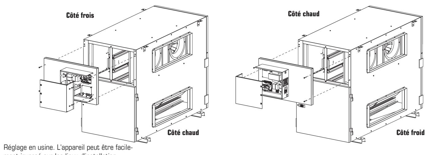
Réglage en usine. L'appareil peut être facilement inversé sur les lieux d'installation.
