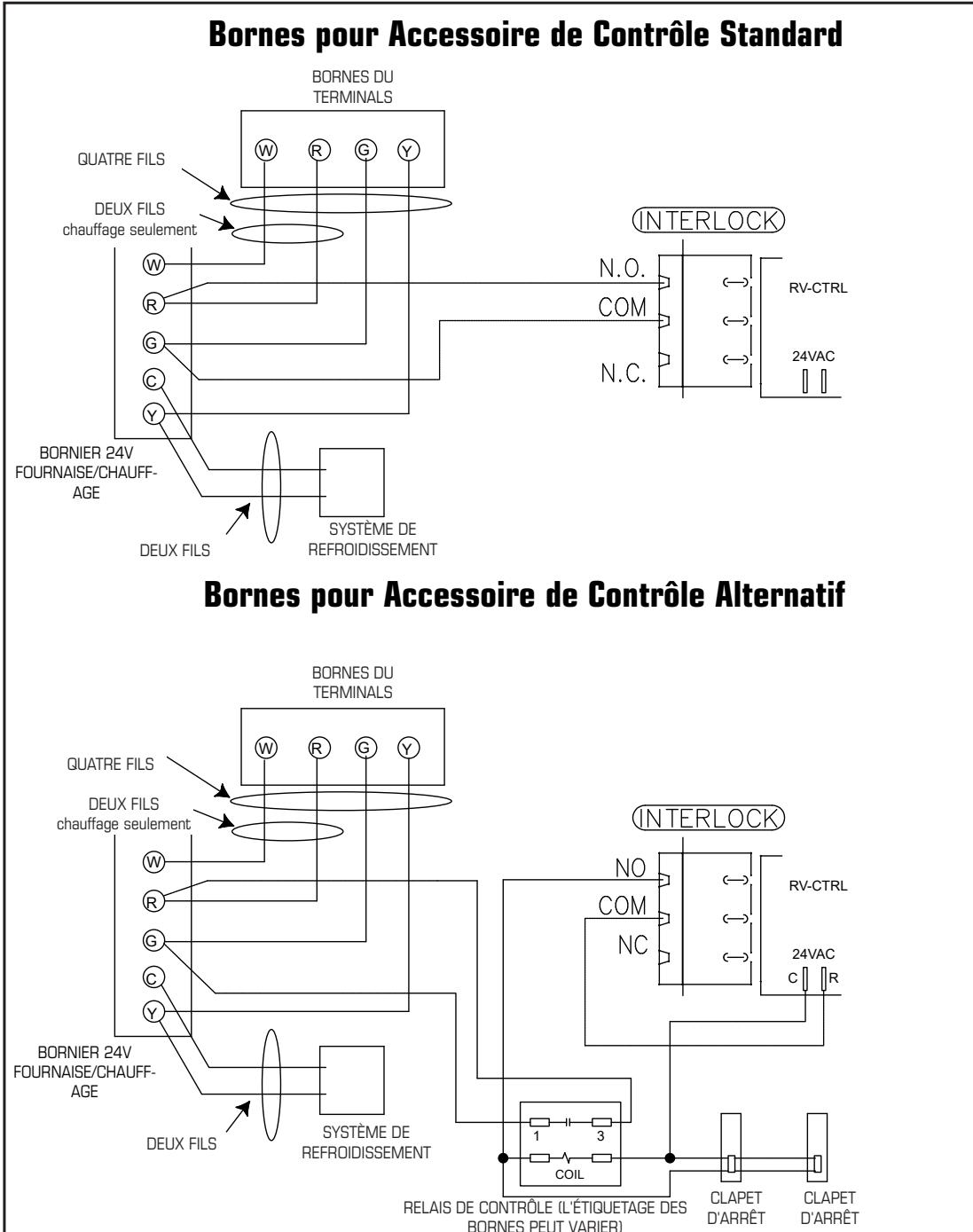
Ne raccordez jamais un courant alternatif de 120V aux bornes des contacts de commande d'accessoires.
