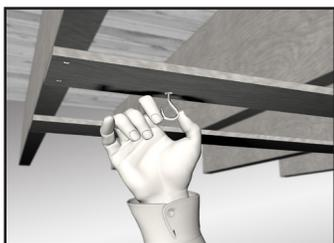
**1** Installez les crochets de fixation sur la fourrure ou les solives de plancher.
