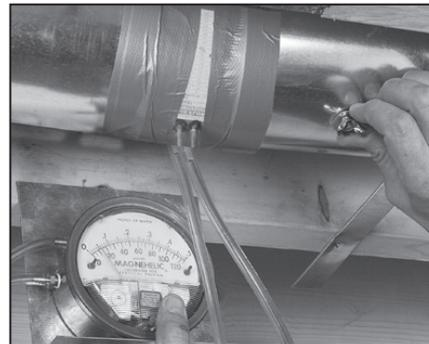
**3** Réglez le registre « Supply Air Out » (sortie de l'air fourni) de façon à obtenir le débit d'air désiré. Suivez les étapes précédentes afin de régler le registre « Exhaust Air Out » (sortie de l'air vicié) au besoin.
