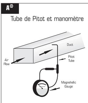
**A** On mesure généralement la vitesse du débit d'air de la gaine avec un manomètre Magnehelic et un tube de Pitot.
