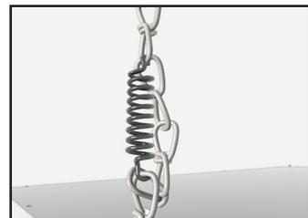
**4** Installez un ressort sur chaque chaîne. Accrochez le ressort de sorte qu'une boucle est créée dans la chaîne. Le ressort supportera le poids du VRC/VRE et absorbera les vibrations.
