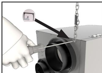
**2** Utilisez un tournevis plat et tirez légèrement sur la languette perforée. Mettez le maillon de la chaîne sous le crochet.
