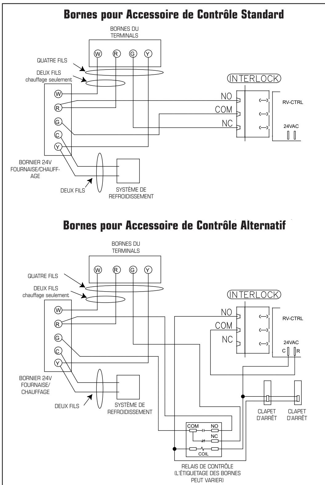
**Ne raccordez jamais un courant alternatif de 120V aux bornes des contacts de commande d'accessoires.
