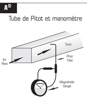
On mesure généralement la vitesse du débit d'air de la gaine avec un manomètre Magnehelic et un tube de Pitot.
