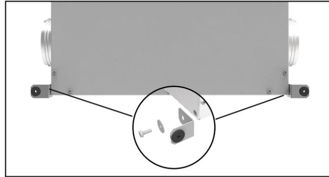
**2** À l'aide de la vis avec rondelle, montez les supports au bas de l'unité.
