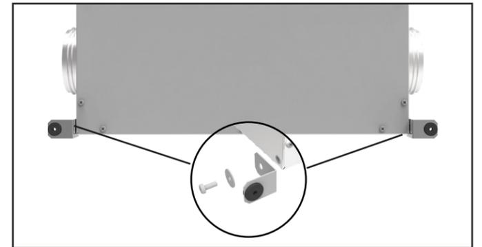
**2** À l'aide de la vis avec rondelle, montez les supports au bas de l'unité.
