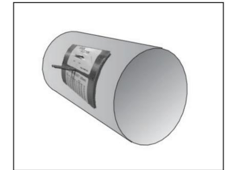
**1** Percez un trou dans le conduit et insérez le poste de mesure des débits. Assurez-vous que la flèche de sens de l'air du poste de mesure des débits pointe dans le sens du débit d'air. Fixez le poste de mesure des débits avec du ruban adhésif.
