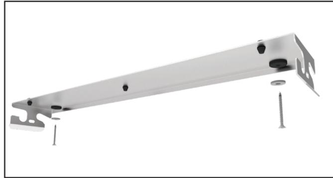
**1** À l'aide de la vis avec rondelle, montez le support de montage à travers l'isolant en caoutchouc. Assurez-vous que le support est droit.
