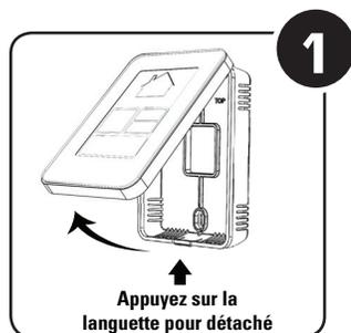
Détachez le module façade de la plaque de montage en appuyant sur la languette (situé en haut et en bas du boîtier de commande).
