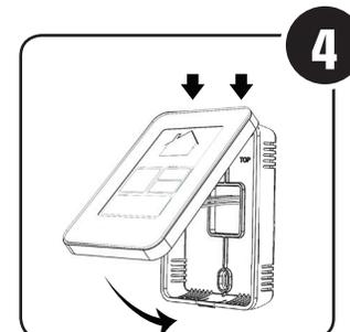
Fixez le module façade de la commande sur la plaque arrière, en insérant tout d'abord la partie supérieure de la commande dans les languettes supérieures, puis en pivotant en appuyant sur la languette du bas, jusqu'à ce que vous entendez un déclic. Vérifiez que le système de ventilation fonctionne.
