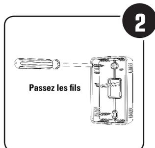
Passez les quatre (4) fils dans l'ouverture centrale de la plaque de montage et montez à l'aide d'une boîte de jonction électrique ou directement sur le mur à l'aide de vis et chevilles d'ancrages.
