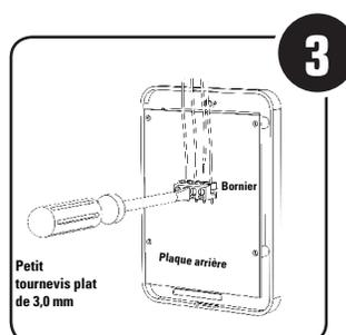
Insérez les quatre (4) fils aux bornes, situés sur la face arrière du module façade de la commande. Sécurisez-les en place en serrant les vis du bornier à l'aide d'un petit tournevis plat de 3,0 mm (non fourni).
