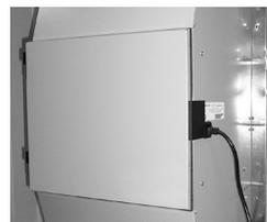
Remplacez la porte et insérez le cordon de raccordement dans le receptacle de l'appareil et l'autre extrémité dans la prise murale.
