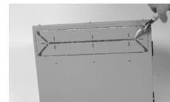
Appliquez la bande scellement tout autour des deux ouvertures sur le dos de l'appareil. Poussez les volets de métal vers l'extérieur approximativement à 90 degrés.
